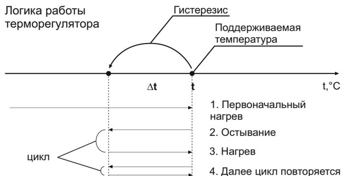
Гистерезис - это разница между температурой включения и отключения контактов реле терморегулятора (падение температуры).
