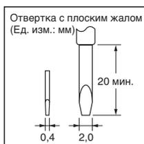
2. Вставьте отвёртку в зазор между передней панелью и корпусом и слегка вытяните переднюю панель. Захватите переднюю панель и полностью выдвиньте ее. Не прикладывайте к панели чрезмерное усилие.
