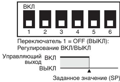
Для управления охлаждением морозильных камер и т.п. установите переключатель 3 в положение ON (ВКЛ).
