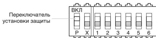
Если переключатель установки защиты находится в положении ON (ВЫКЛ), клавиши Up (Больше) и Down (Меньше) блокируются, что позволяет предотвратить случайную перенастройку параметров.
