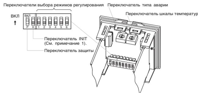
**Примечание: 1.** Для работы в обычном режиме переключатель INIT всегда устанавливается в положение OFF (ВЫКЛ).
