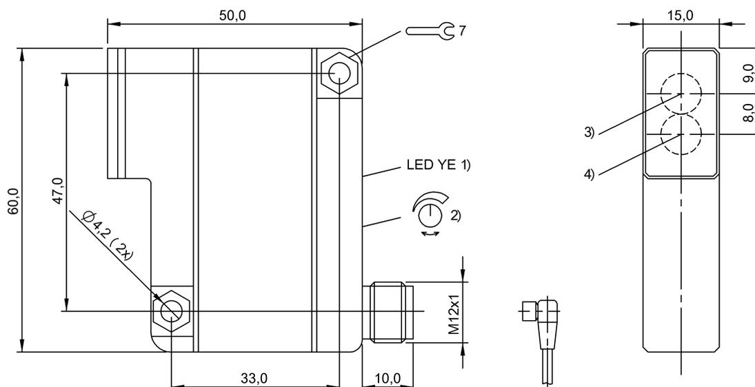
1) Функция выхода, 2) Sn, 3) Оптическая ось, передатчик, 4) Оптическая ось, приемник
