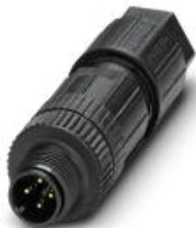
Conector, 4-polos, Conector macho recto M12, codificado A, Conexión push-in, material de moleteado: Plástico, diámetro exterior del cable 4 mm ... 8 mm
